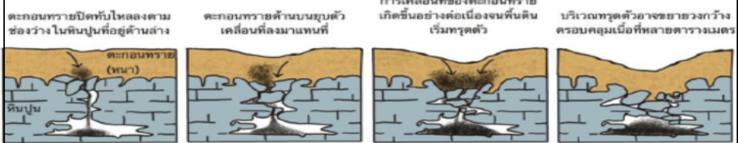
หลุมยุบที่เกิดจากการทรุดตัว (Subidence sinkhole)
