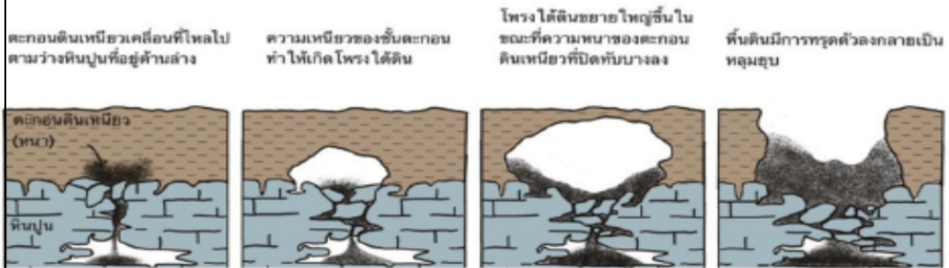
หลุมยุบที่เกิดจากการพังถล่มหรือพังทลายของชั้นหินชั้นดิน (Collapse sinkhole)
