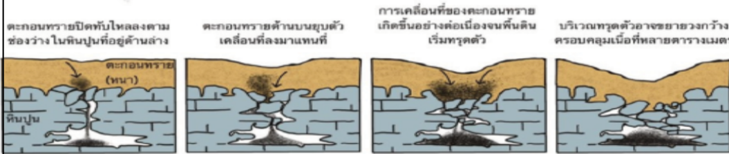
หลุมยุบที่เกิดจากการทรุดตัว (Subsidence sinkhole)
