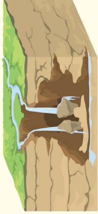
3 น้ำใต้ดินกัดเซาะและขยายรอยแตกให้กว้างใหญ่ขึ้น
