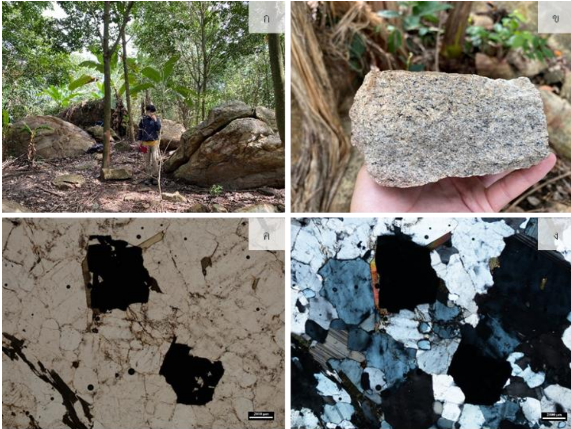
รูปที่ 3-14 (ก) หินโผล่บริเวณ พิกัด: 765153E 1476818N 47N ใกล้เนินเขาสี่เสียด บ้านคลองโอง ตำบลวัดสุวรรณ อำเภอบ่อทอง จังหวัดชลบุรี มุมมองในรูปไปทางทิศตะวันออก (ข) ตัวอย่างหินฮอร์นเบลนด์-ไบโอไทต์แกรนิต เนื้อผลึกสม่ำเสมอขนาดปานกลางถึงหยาบ ผลึกมีขนาด 2-5 มม. ประกอบด้วย เฟลด์สปาร์ ควอตซ์ไบโอไทต์ และฮอร์นเบลนด์ แร่ดำพบมีปริมาณร้อยละ 10-15 ของเนื้อหิน มีค่าสภาพรับไว้ได้ของแม่เหล็กประมาณ 17.312 \times 10^{-3} SI และค่า K=4.5 % U=25.3 ppm และ Th=82.9 ppm (ค) ศิลาวรรณนาของหินภายใต้ Plane-polarized light พบผลึกแร่ทึบแสงที่มีรูปผลึกแบบไอโซเมตริก เป็นแร่แมกนีไทต์ (ง) ลักษณะศิลาวรรณนาของหินภายใต้ Cross-polarized light พบผลึกแร่ควอตซ์ แร่แพลจิโอเคลส และแร่ไบโอไทต์ (สีชมพูส้ม)
