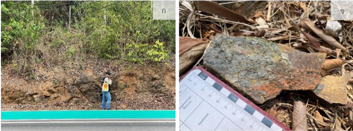
รูปที่ 3-20 (ก) หินโคลนบริเวณ พิกัด: 714950E 1411461N 47N ตรงข้ามโครงการป่าสิริเจริญวรราชอันเนื่องมาจากพระราชดำริ ริมทางหลวงชนบท ขบ.1003 บ้านเขาชีจรรย์ ตำบลนาจอมเทียน อำเภอสัตหีบ จังหวัดชลบุรี มุมมองในรูปไปทางทิศตะวันตกเฉียงเหนือ (ข) ตัวอย่างหินทรายทรายแป้งที่มีจุดประ มีค่าสภาพปรับไว้ได้ของแม่เหล็กประมาณ 0.199 \times 10^{-3} SI และมีค่า K=5.3 % U=7.1 ppm และ Th=26.2 ppm
