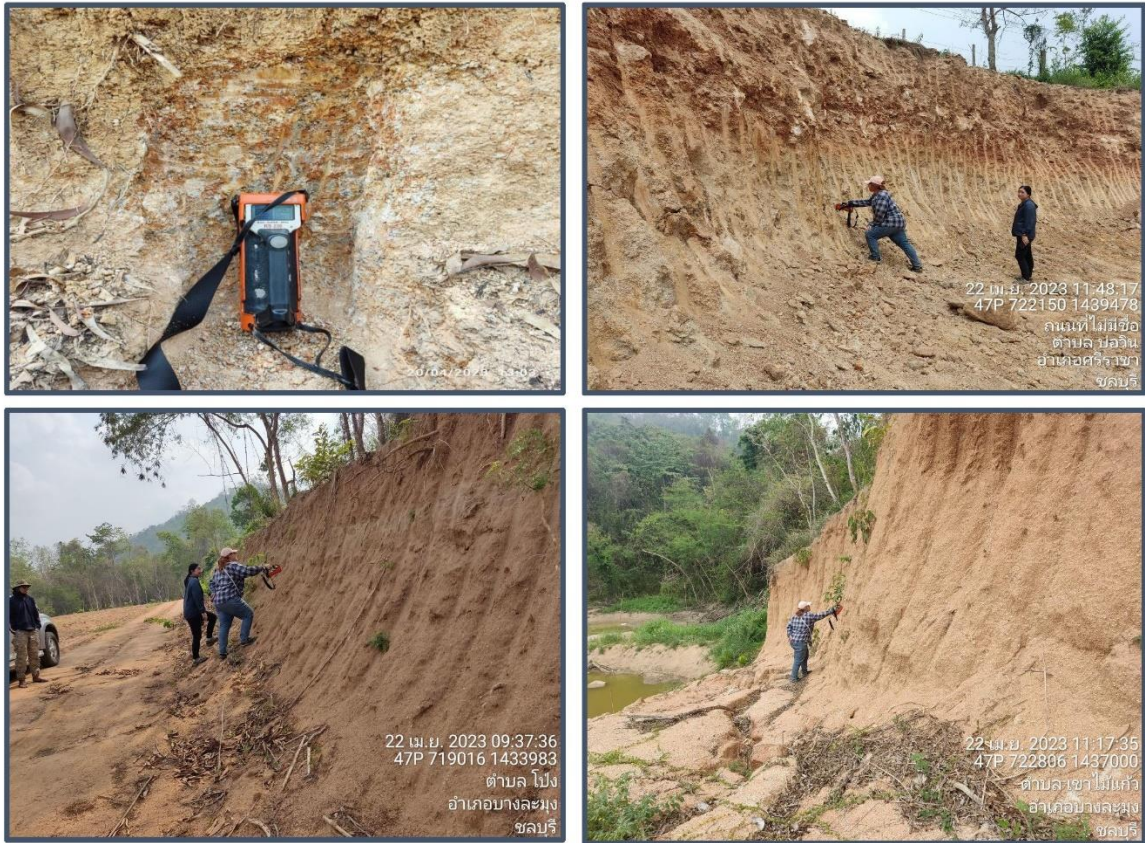
รูปที่ 5-27 รูปถ่ายแสดงกิจกรรมการวัดค่ากัมมันตรังสีในจุดเก็บตัวอย่างดิน/หินผุ (Soil profile) โดยใช้เครื่องมือ Portable gamma-ray spectrometer
