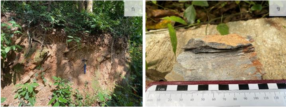
รูปที่ 3-16 (ก) หินโคลนบริเวณ พิกัด: 753521E 1480173N 47N ทางเข้าวัดเขานางนม บ้านเขานางนม ตำบลท่าบุญมี อำเภอเกาะจันทร์ จังหวัดชลบุรี มุมมองรูปไปทางทิศเหนือ (ข) ตัวอย่างหินฟิลไลต์มีสภาพผุพังสูง พบแนวร้าวขนานที่แสดงการเรียงตัวของแร่ไมกาภายในแนวตะวันตกเฉียงเหนือตะวันออกเฉียงใต้ ( 300^\circ ) มีค่าสภาพปรับไว้ได้ของแม่เหล็กประมาณ 0.041 \times 10^{-3} SI และมี K=1.4\% U=4.3 ppm และ Th=12.1 ppm
