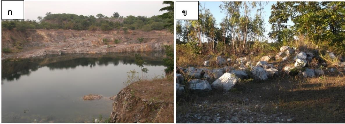
รูปที่ 5-31 เหมืองแร่เฟลด์สปาร์ในพื้นที่ศักยภาพแร่เฟลด์สปาร์แม่สลิด (ก) ขุมเหมืองแร่เฟลด์สปาร์ มีการผลิตแร่ ปัจจุบันลึกประมาณ 30 เมตร และ(ข) กองแร่เฟลด์สปาร์สีขาวที่ขุดขึ้นมาจากขุมเหมืองของบริษัท เซอมาส จำกัด พิกัด 0525546, 1884202 N
