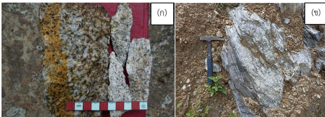
รูปที่ 7-21 (ก) หินไปโอไทต์ มัสโคไวต์แกรนิต เนื้อดอก หน่วยความเข้มกัมมันตรังสี R5a บริเวณ ตำบลโมโกธ อำเภออุ้มผาง จังหวัดตาก พิกัด 47Q 503097 1801779 (Mag=0.04 K=5.08 U=23.03 Th=19.57) * (ข) หินไนส์ ที่แสดงแถบชั้นสีขาวมากกว่าสีดำ หน่วยความเข้มกัมมันตรังสี R5a บริเวณ ตำบลด่านแม่ละเมา อำเภอแม่สอด จังหวัดตาก พิกัด 47Q 495060 1857473 ( Mag=0.11 K=4.42 U=34.2 Th=74.4) *
