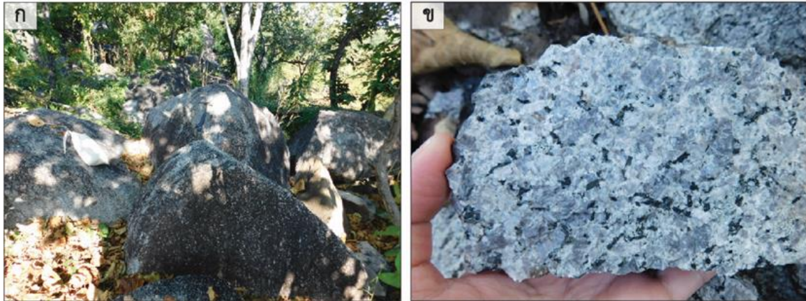
รูปที่ 4-36 หินฮอร์นเบลนด์-ไบโอไทต์แกรนิต ยุคไทรแอสซิก (ก) หินโผล่หินฮอร์นเบลนด์-ไบโอไทต์แกรนิต บริเวณทางน้ำล้นอ่างเก็บน้ำบ้านยางโอง ตำบลแม่สลิด อำเภอบ้านตาก จังหวัดตาก ที่พิกัด 47Q 0517913E 1897855N (ข) หินฮอร์นเบลนด์-ไบโอไทต์แกรนิต เนื้อสม่ำเสมอ ผลึกขนาดหยาบ
