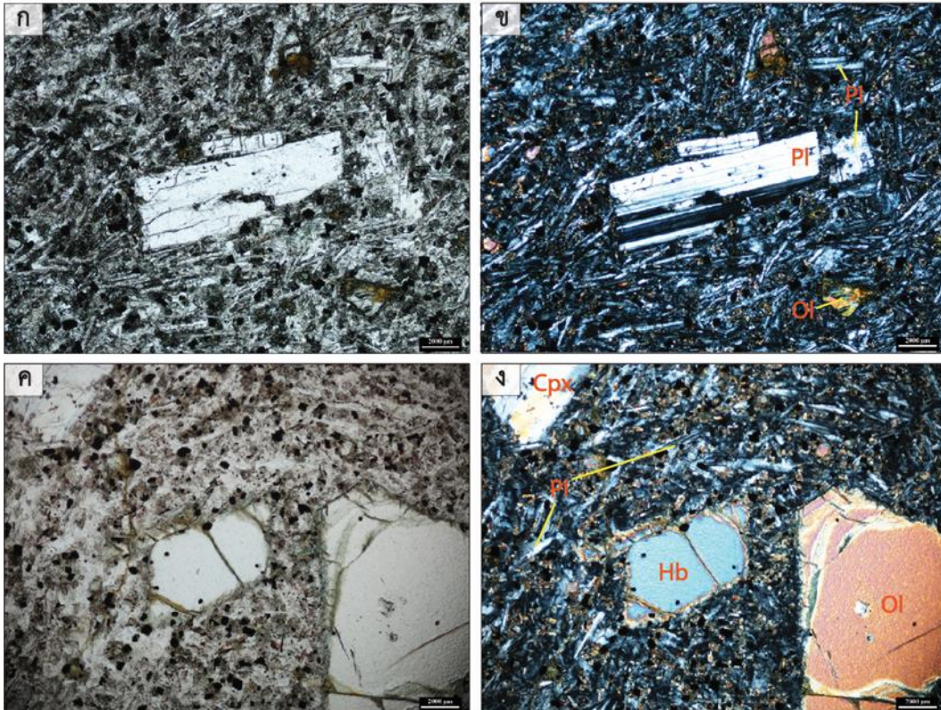
รูปที่ 4-50 (ก)-(ง) เนื้อหินของ massive basalt ภายใต้กล้องจุลทรรศน์ บริเวณห้วยเล็ก บ้านแม่วะหลวง ตำบลแม่วะหลวง อำเภอท่าสองยาง จังหวัดตาก แร่ประกอบหินประกอบด้วย แร่โอลิวีน(OL) แร่แพลจีโอเคลส (Pl) แร่ฮอร์นแบรอน (Hb) แร่โคโนไพรอกซีน (Cpx) และแร่ทึบแสง ((ก) และ (ค)= Plan polar light, (ข) และ (ง)=Cross-Polar light)
