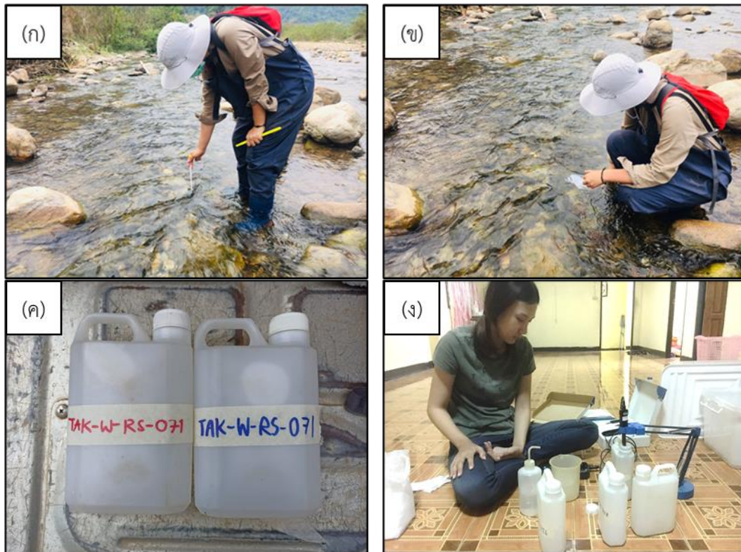
รูปที่ 6-4 การเก็บตัวอย่างน้ำผิวดิน (ก) วัสดุอุปกรณ์น้ำผิวดิน (ข) การเก็บตัวอย่างน้ำผิวดินแบบจ้วง (ค) ถ่ายรูปตัวอย่างน้ำผิวดิน (ง) ตรวจสอบคุณภาพตัวอย่างน้ำผิวดิน และจดบันทึกข้อมูล
