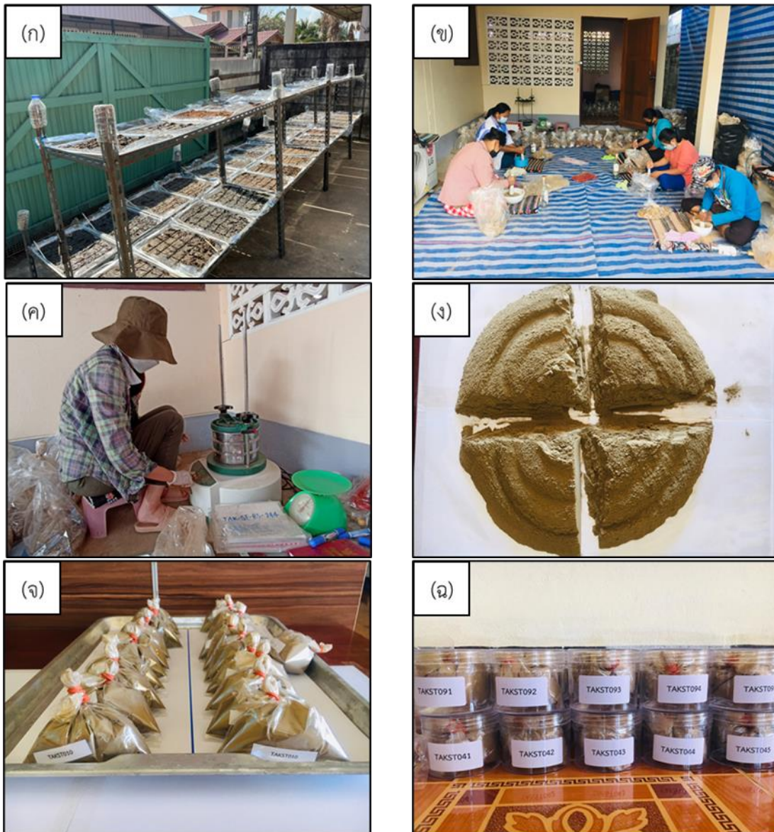
รูปที่ 6-5 การเตรียมตัวอย่างตะกอนธารน้ำ (ก) การนำตัวอย่างตะกอนมาผึ่งแดดให้แห้งสนิท (ข) การบดตะกอนด้วยโม่บดยา (ค) การร่อนตะกอนผ่านตะแกรงขนาด 80 เมช (ง) การแบ่งตัวอย่างด้วยวิธี Coning and Quartering (จ) การบรรจุตัวอย่างเพื่อส่งวิเคราะห์ทางเคมี (ฉ) การบรรจุตัวอย่างเพื่อเก็บเป็นตัวอย่างอ้างอิง
