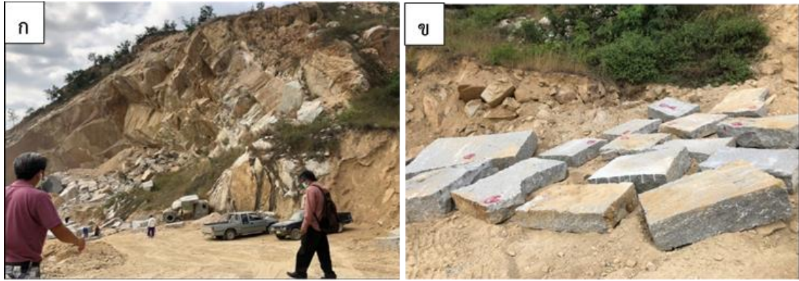
รูปที่ 5-5 ลักษณะหินแกรนิตชนิดหินประดับในเหมืองบริษัทสหสงมายิ่ง อำเภอเมืองตาก พิกัด 516918 E 1874416 N (ก) รูปภาพแสดงหน้าขุมเหมืองของหินแกรนิตชนิด ไบโอไทต์แกรนิตยุคไทรแอสสิก (ข) บล็อกหินแกรนิตเพื่อเตรียมแปรรูปตัดเป็นแผ่นให้เป็นหินแกรนิตชนิดหินประดับเพื่อส่งขาย
