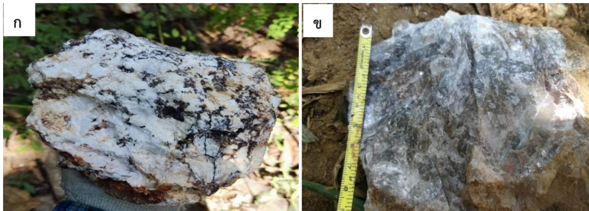
รูปที่ 5-36 ลักษณะของแร่แบไรต์ที่พบอำเภอแม่สอด จังหวัดตาก ลักษณะของแร่แบไรต์ที่พบในพื้นที่ศักยภาพแร่แบไรต์แหล่งแม่ละเมา1 ลักษณะของแร่แบไรต์บนเนื้อแร่ควอตซ์ที่พบในพื้นที่ศักยภาพแร่แบไรต์แหล่งพะวอ6
