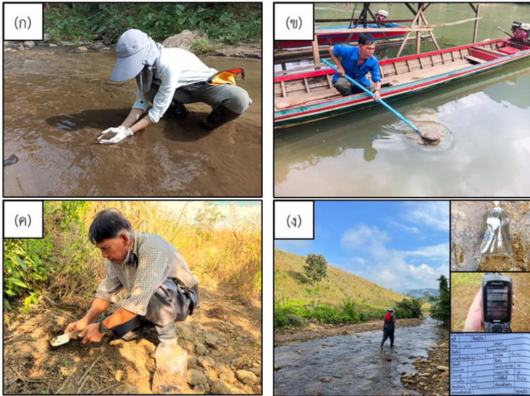
รูปที่ 6-3 การเก็บตัวอย่างตะกอนธารน้ำ (ก) การเก็บตะกอนธารน้ำด้วยมือบริเวณริมตลิ่งในระดับผิวน้ำ (ข) การเก็บตะกอนธารน้ำโดยใช้กระบวยตักกรณีน้ำลึก (ค) การเก็บตะกอนธารน้ำกรณีธารน้ำแห้ง (ง) ถ่ายรูปตัวอย่างตะกอนธารน้ำ สภาพพื้นที่ และจดบันทึกข้อมูล
