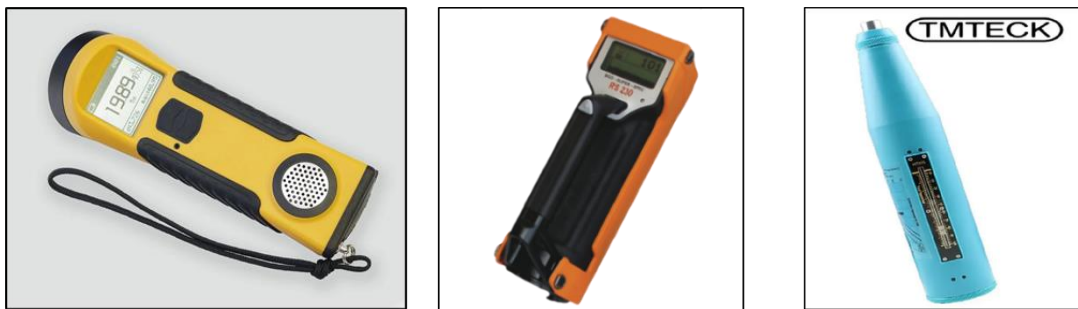
รูปที่ 7-11 เครื่องมือ Magnetic Susceptibility เครื่องมือ Gamma Ray Spectrometer เครื่องมือ Schmidt Rebound Hammer
