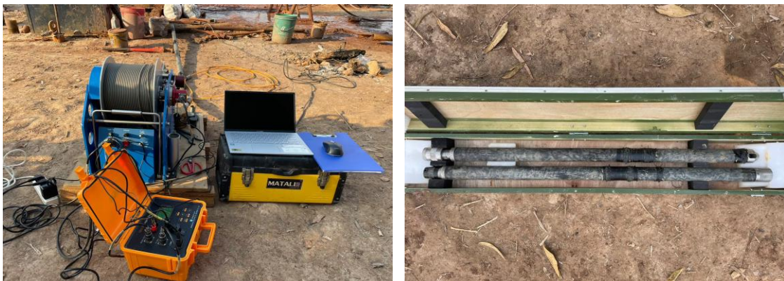
รูปที่ 3.14 อุปกรณ์ยังธรณีฟิสิกส์หลุมเจาะ (ซ้าย) และหัวโพรวัดค่าแกมมาธรรมชาติ (ขวา)
