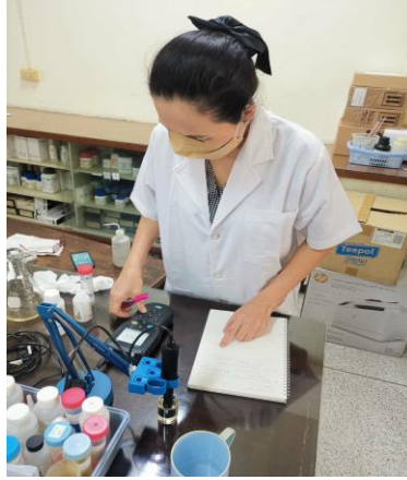
รูปที่ 5 การตรวจวัดค่าการนำไฟฟ้า โดยใช้เครื่อง pH – Conductivity meter
